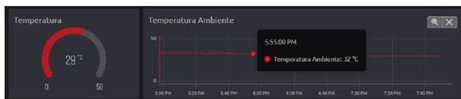
Figura 35 – Medição de temperatura no Blynk Console
