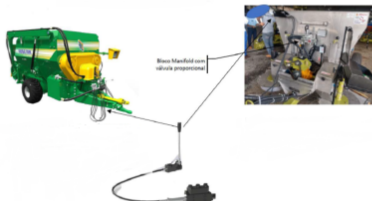
Figura 8 – Representação de um implemento agrícola com sistema hidráulico independente
