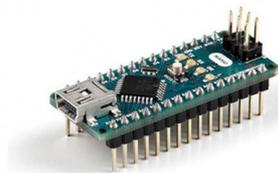
(a) Plataforma de prototipagem eletrônica de hardware livre e de placa única, Arduino Nano. Fonte: Arduino (2018).
